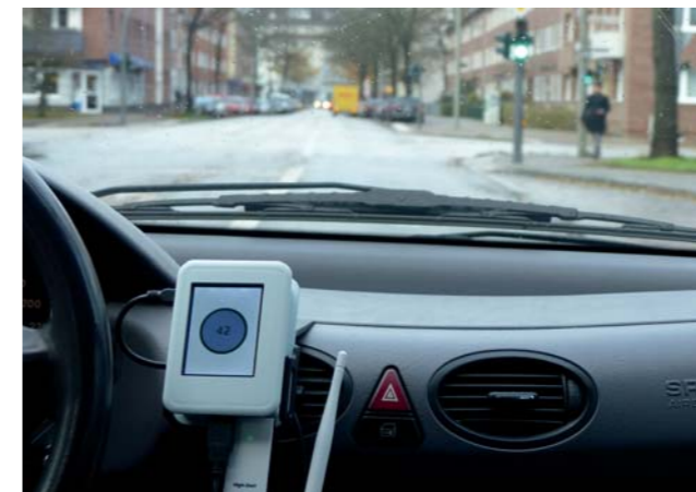
Das Beratungssystem im Auto zeigt an, mit welcher Geschwindigkeit zu fahren ist, um die Ampel in ihrer Grünphase anzutreffen.
