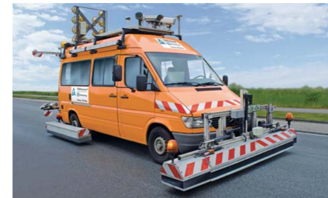
Mit Sensoren und Kameras ausgestattete Fahrzeuge erfassen die Oberflächeneigenschaften der Straße.
